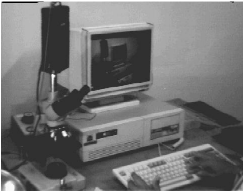
Microcomputadora conectada a una cámara de video que se acopla a un microscopio.
